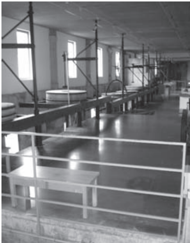
Imagen de los molinos en el interior del edificio, con las piedras desprovistas de vestimenta.
