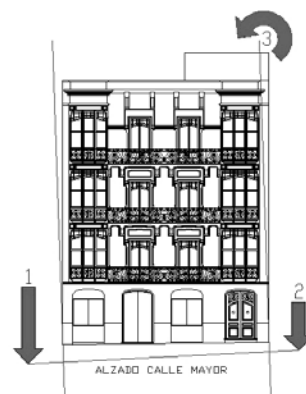
Figura 12. Esquema representativo de los asientos que padecía la fachada principal de la casa Llagostera (1 y 2) y movimiento de giro provocado por los mismos (3).
